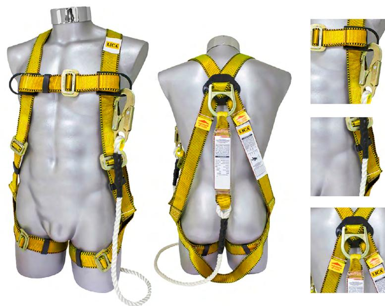
Arnés con anillo "D" en la espalda y amortiguador de impacto con cable de cuerda nailon de 1/2" de diámetro. Básicamente un artículo que combina los atributos del ARN-L y el C-ARN-L. Estos equipos deben ser conectados a estructuras que son capaces de resistir 2,268 kg.
